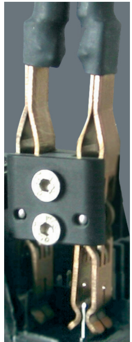
80 A Kontaktklemme (in der Anwendung) Gebrauchsmuster DE 20 2006 006 957 U1
