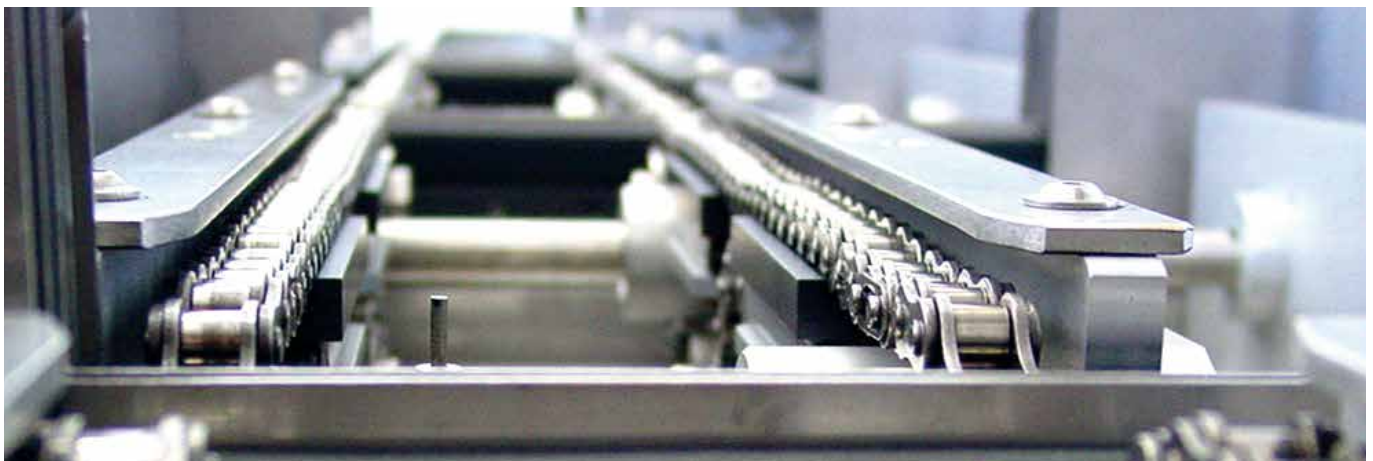
Kettentransportsystem im heißen Bereich
