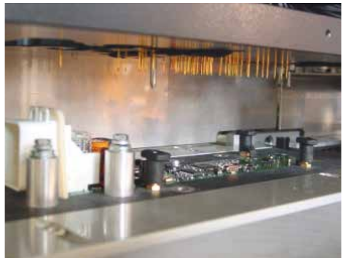
Kontaktierstation mit wechselbarem Nadelbett
